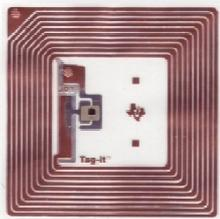
Figura 11 – Tag antitaccheggio inserito sotto l’etichetta del codice a barre
