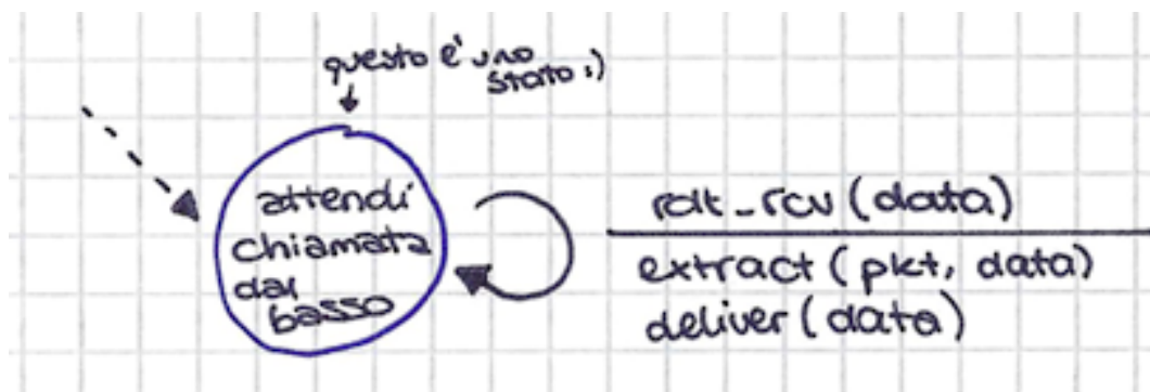
Figure 6: RDT 1.0, lato ricevente. Quando viene ricevuta una chiamata “receive(data)”, estrae i dati dal pacchetto (extract) e li consegna al layer sopra (deliver). Come dicevamo, nessuno dei due lati fa nient’altro.
