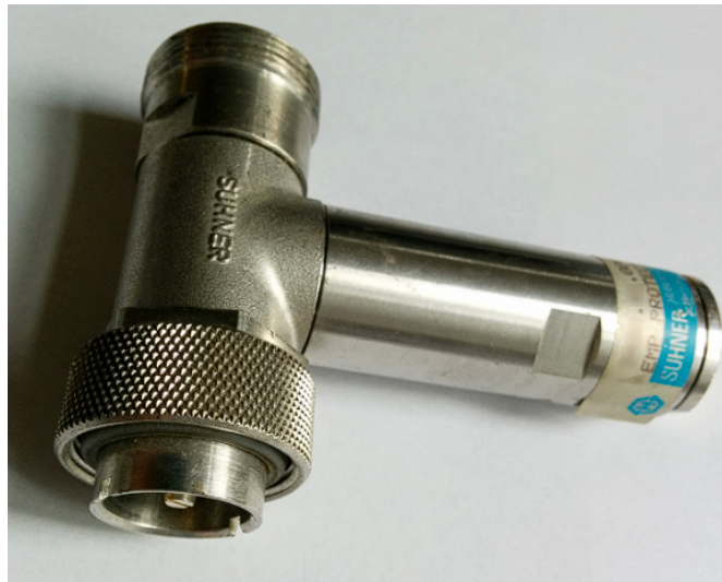
Figure 22: Connettore T per reti Thinnet. All'estremità "lunga" viene collegato il terminale, a quelle corte rispettivamente l'input e il resto del ring (o un Terminatore, tipo un tappo a impedenza 50\Omega di tipo BNC come le altre estremità dei coassiali)
