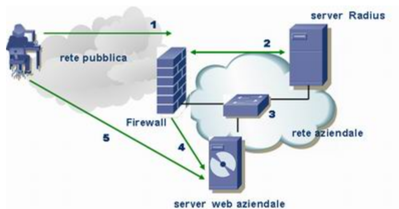
Figura 3.1 Principio di funzionamento sistema di autenticazione
