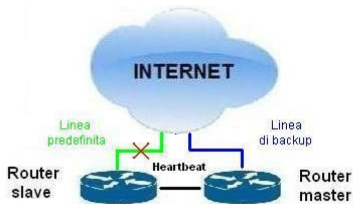
Figura 10 Router ridondato con collegamento Heartbeat
