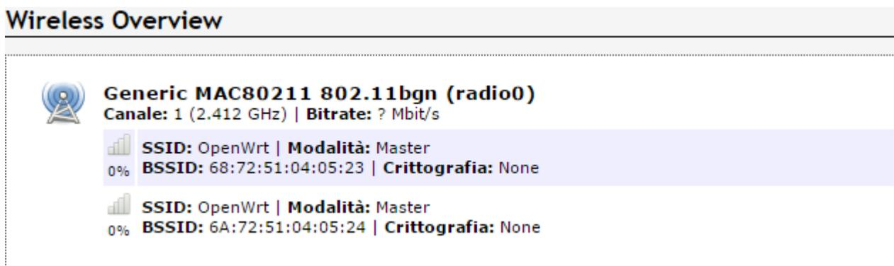
Ora che sono state create le reti Wireless basterà impostare la crittografia su WPA2 ed inserire nei campi richiesti l’indirizzo ip del server Radius/Ldap, la relativa password e la porta utilizzata tralasciando la sezione inerente l’accounting.
