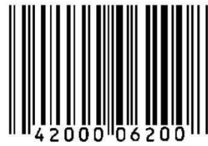
Figura 3.2: Esempio di barcode con codifica EAN.
