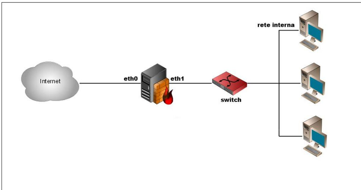
La macchina rappresentata in nero, è il sistema di prova. Come è possibile notare è stata fornita di due schede di rete rispettivamente nominate eth0 e eth1. La simbologia appare abbastanza chiara. La macchina in questione è adibita principalmente al ruolo di gateway e firewall. E' posta tra la rete esterna e quella interna. Quest'ultima è composta da un numero arbitrario di host e il traffico è smistato da un semplice switch.
