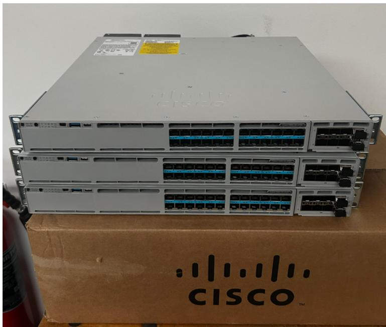
Figura 3.1: C9300X con moduli SFP
