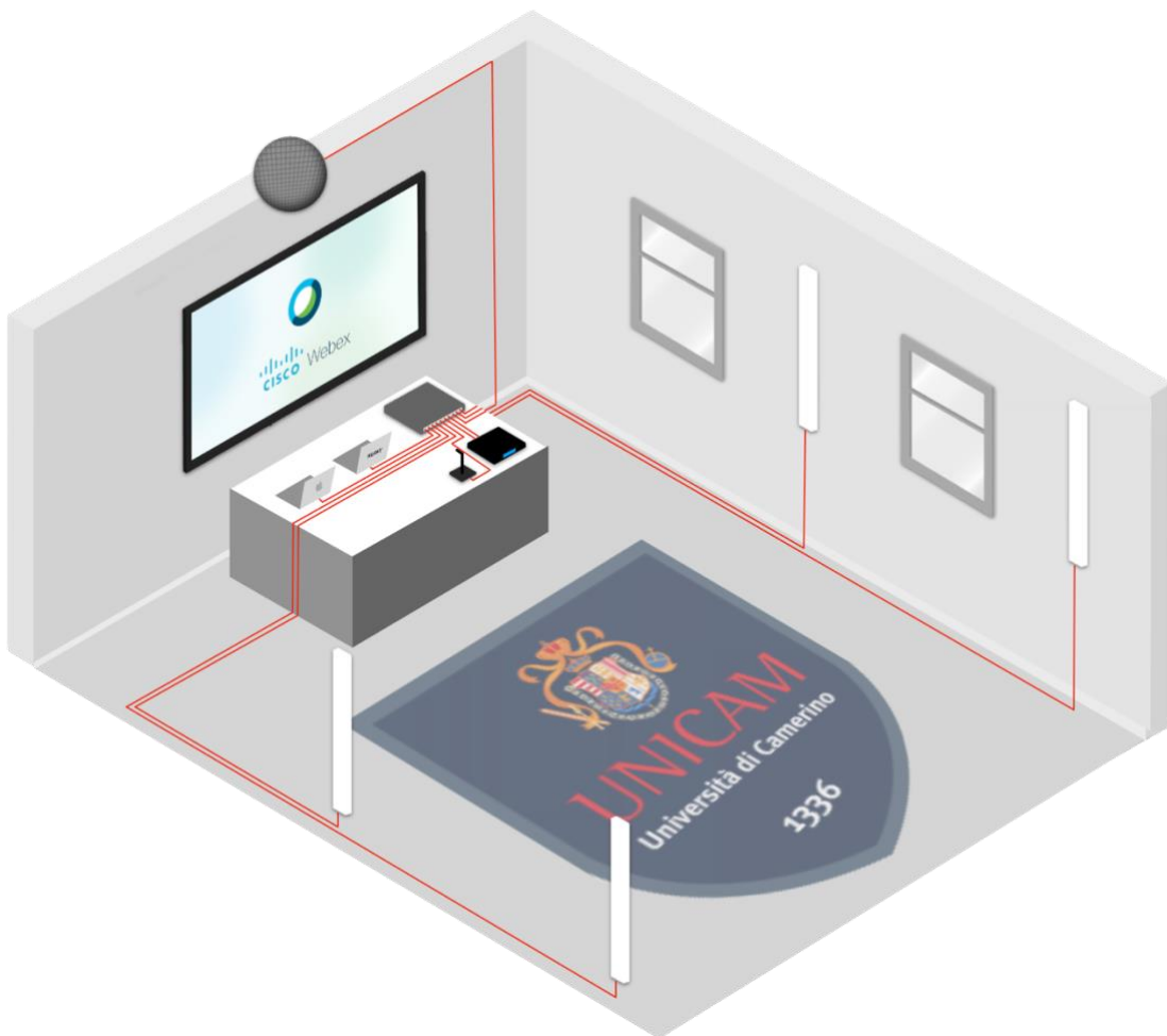
Figura 2.1: Cablaggio di audio networking per un'aula universitaria
