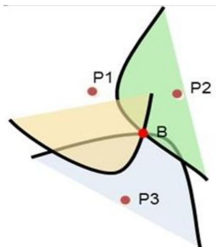
posizione del tag utilizzando una tecnica nota come multi-lateration. La difficoltà di implementazione di questo sistema è dovuta alla corretta sincronizzazione del clock interno dei dispositivi, che rende difficile e costosa la progettazione hardware e l'installazione del sistema.
