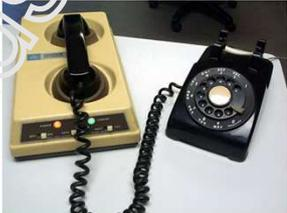
Accoppiatore acustico L'accoppiatore acustico è un dispositivo che consente la ricezione e la trasmissione dei dati attraverso l'uso di un semplice microtelefono di un apparato telefonico. E' un'apparecchiatura utilizzata nei primi modelli di modem.
