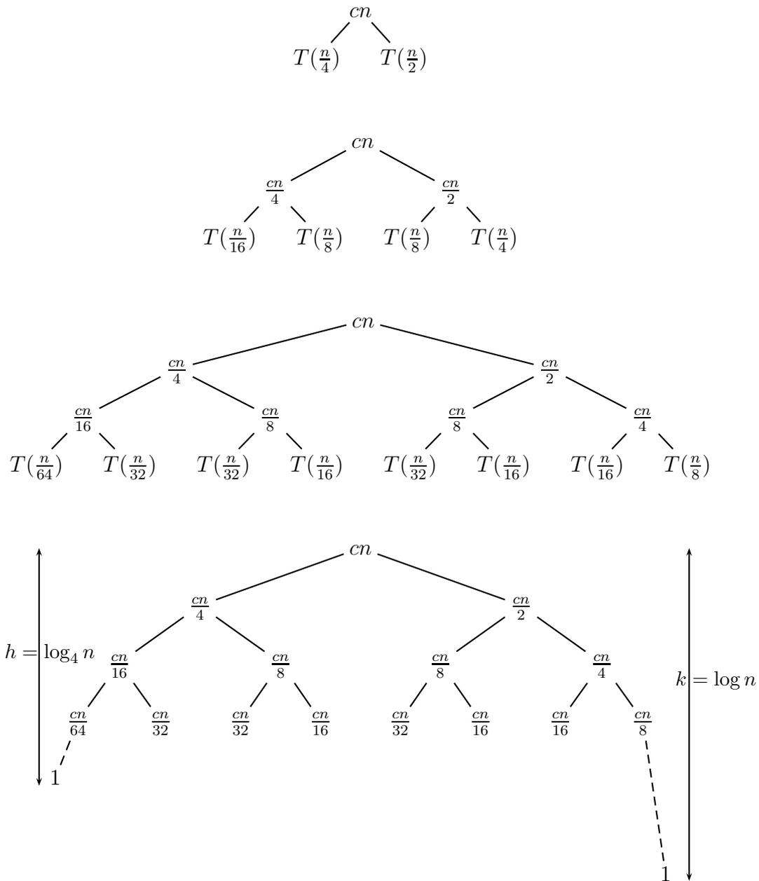
Figure 2: Albero di ricorsione per  $T(n) = T(\frac{n}{4}) + T(\frac{n}{2}) + cn$
